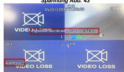
Abschaltverzögerung bei Niederspannung Abb. 44
